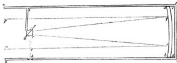
Abb. 69. Newtons schematische Zeichnung seines Spiegelteleskops.
